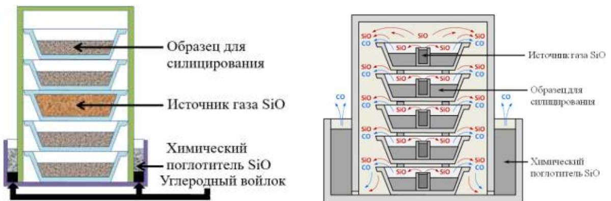
Рисунок 4.17 – Схемы лабораторных реакторов для силицирования карбидных порошков ZrC (реактор «В2» и реактор «Г»).
